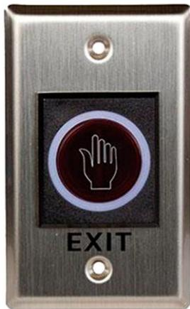
El botón K1 ofrece el novedoso concepto “sin contacto” al incorporar un sensor óptico-infrarrojo que permite realizar la solicitud de apertura de una puerta sin la necesidad de hacer contacto físico con el botón,
